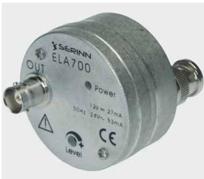
Amplificatore video di dimensioni estremamente contenute, per segnali COLORE e B/N, realizzato in corpo di Anticorodal, completo di spina BNC lato telecamera e presa BNC lato Video/OUT. L'amplificatore si presta al montaggio diretto sul BNC/OUT della telecamera e si collega all'alimentazione della stessa tramite il cavo in dotazione. Completo di LED di presenza alimentazione e Trimmer per la regolazione fine del fattore di amplificazione.
